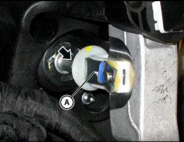
● 拆下指示的夹子，分离连杆 (A)。
